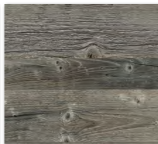
smreka 5C (surova površina) 1,3 Površina ožgana s soncem, rahlo krtačena in ročno popravljena z lesnimi krpami. Struktura prečna ali vzdolžna.
